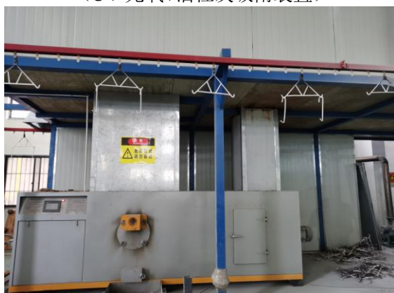
热风炉 TA003 (低氮燃烧)
