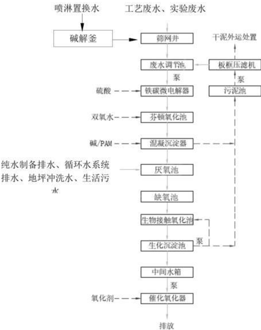
图 4.1-1 废水处理工艺流程图
