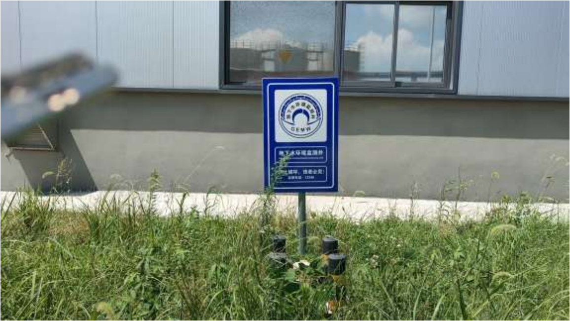
图4.2-2 地下水监控井
